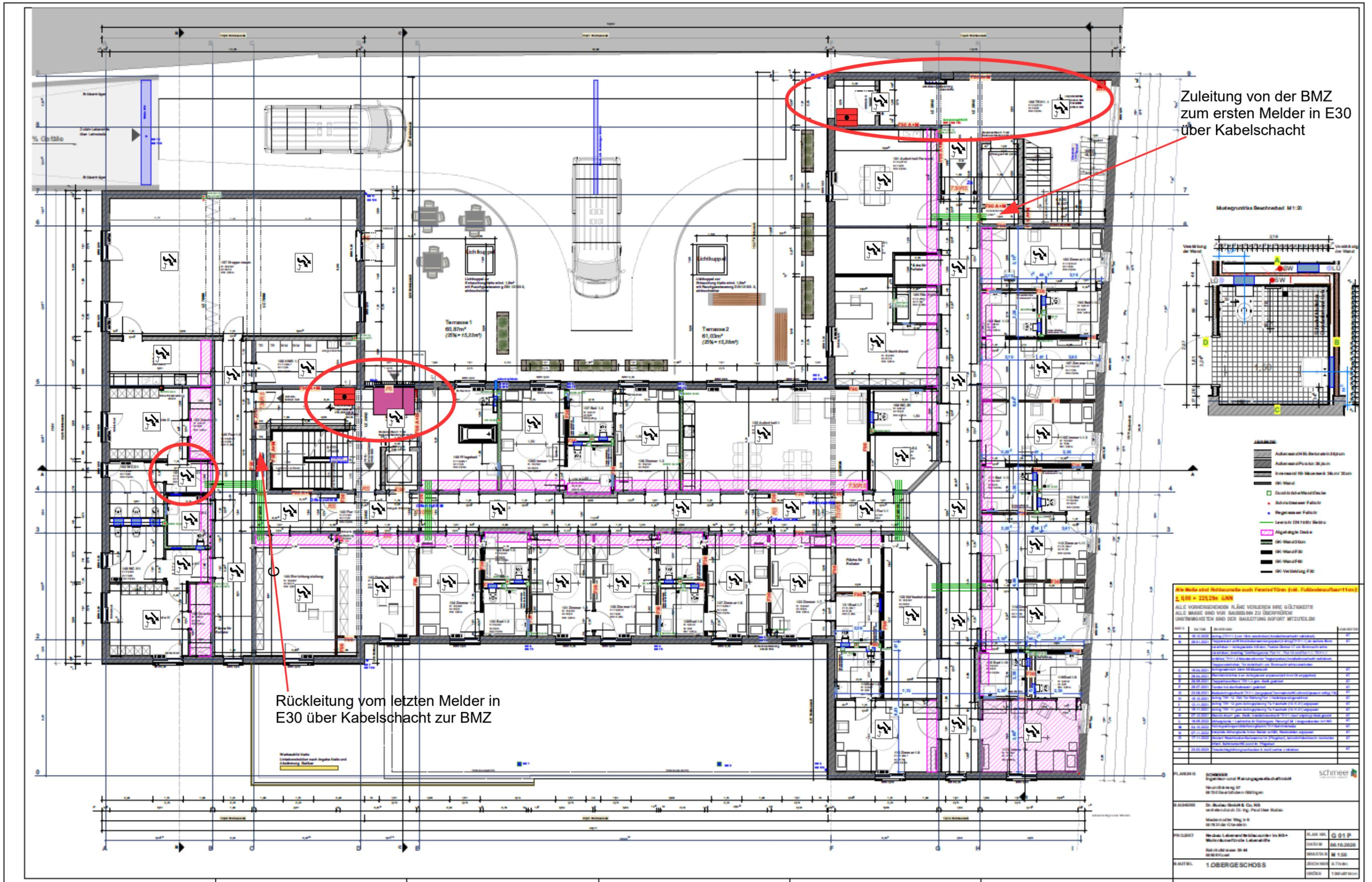
Zuleitung von der BMZ zum ersten Melder in E30 über Kabelschacht
